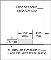
Ubicación de la toma de agua (ICBIW-30CI).
